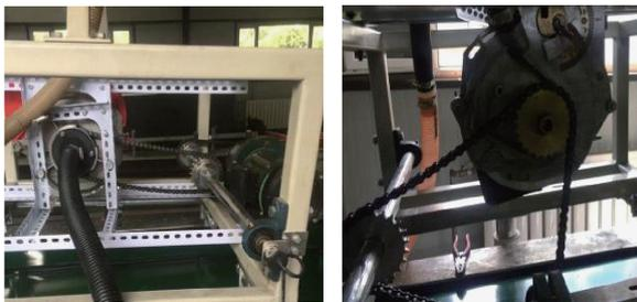
(a) 嵌入旋转气腔式排种器 (b) 存在摩擦的气吸式排种器
