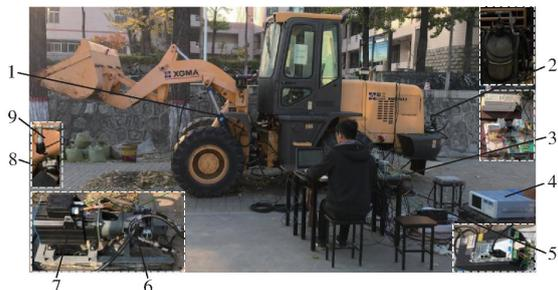
图7 闭式泵控三腔液压缸举升装置试验样机
