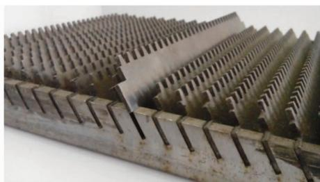
图 9 仿生脱粒齿形试验部件实物
