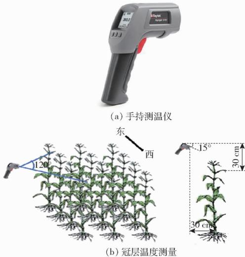
图 2 玉米冠层温度测量示意图
