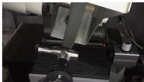
图 9 六轴联动数控机床实际加工过程
