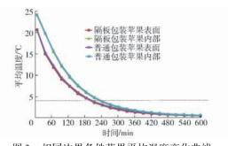
图 3 相同边界条件苹果平均温度变化曲线
