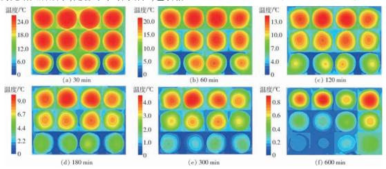
图 7 冷却过程中不同时间下隔板包装内的温度分布云图
