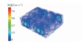
图 10 冷却 120 min 普通包装的风速分布图
