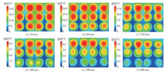
冷却过程中不同时间下普通包装内的温度分布云图
