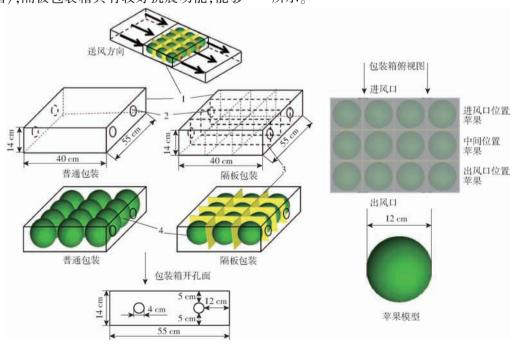
图 1 两种包装箱箱体的结构示意图
