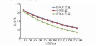
图 13 风速 2.5 m/s 不同位置苹果温度实验曲线 Fig. 13 Experimental temperature at different positions
