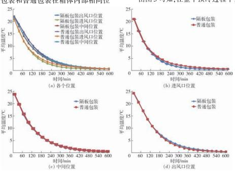
图 4 相同边界条件两种包装不同位置苹果内部平均温度曲线
