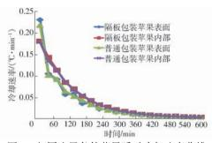
图 5 相同边界条件苹果瞬时冷却速率曲线
