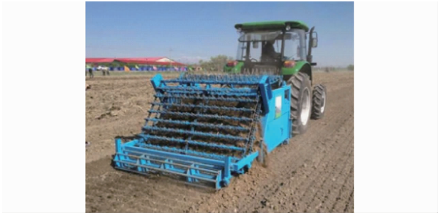
图 8 改进后弹齿式残膜回收机田间性能试验
