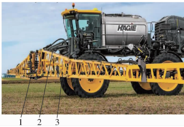
图 4 海吉 STS16 型喷雾机梯形立体桁架喷杆结构 Fig. 4 Spray boom structure of Hagie STS16 sprayer in type of trapezoid space truss
