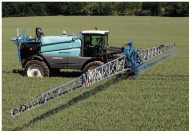
图 3 波尔图 Raptor4240 型喷雾机三角形立体桁架喷杆结构
