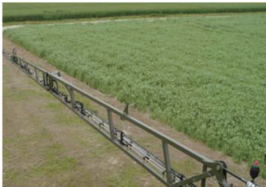
图 2 泰克诺玛 Laser5240 型喷雾机喷杆结构 Fig. 2 Spray boom structure of Tecnomas Laser5240 sprayer
