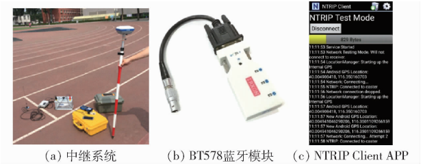
图 6 基于 Phone 的 GNSS 差分增强中继试验系统
