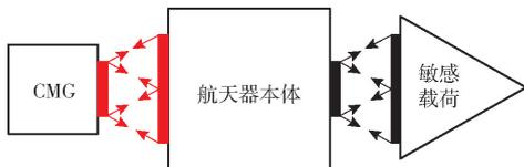
图1 含隔振器的航天器结构示意图
