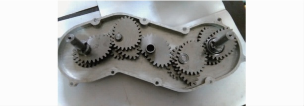
图 17 齿轮的初始安装位置图
