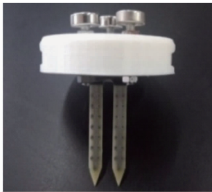
图 5 土壤水分监测传感器功能头
