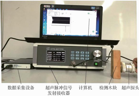
图3 植物茎体超声回波检测现场图
