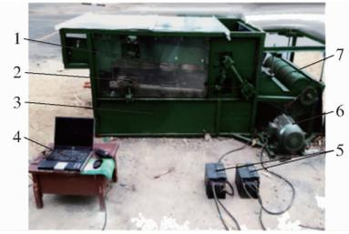
图 8 聚氨酯橡胶筛试验台架
