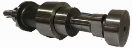
图 12 优化后实验用凸轮轴
