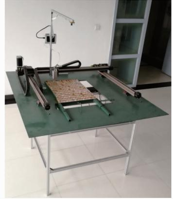
图 9 基于机器视觉的直角坐标式方格簇自动采茧机样机
