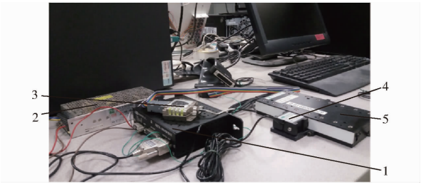
图 1 摩擦传动的压电定位台控制系统 Fig. 1 Piezoelectric positioning control system with friction-driven
