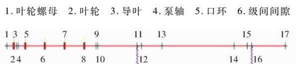
图5 一维梁-弹簧-集中质量模型
