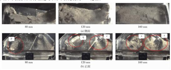
图 4 不同叶板宽度时侧面和正面高速摄像图
