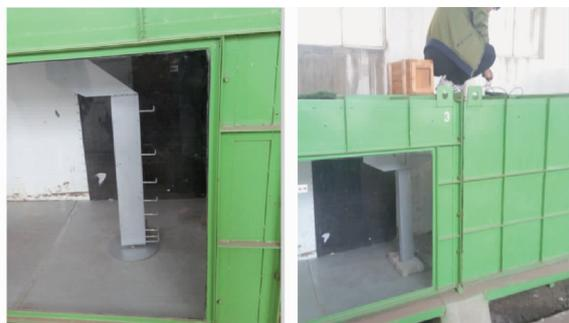
图 12 风速廓线仪风洞测试
