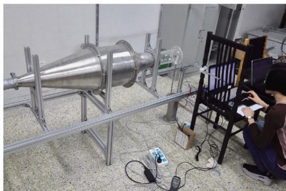
图10 风速传感器标定试验装置
