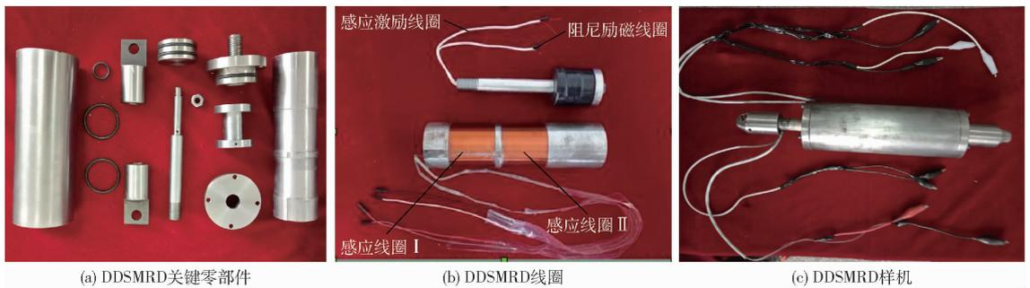
图 3 DDSMRD 的关键零件及样机
