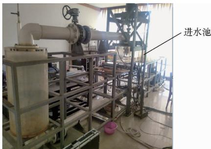
图 1 立式轴流泵模型装置试验台
