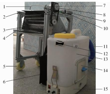
图1 梳割气吸一体式贡菊采摘机试验样机
