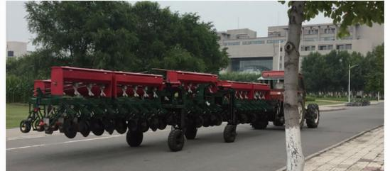
图 18 样机道路运输试验
