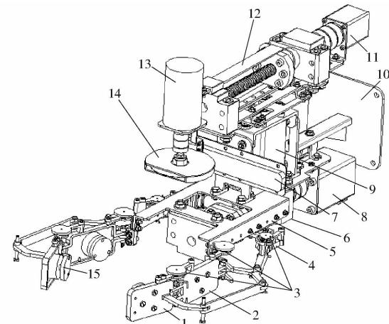
图 1 抓持-旋切式欠驱动双指手葡萄采摘装置
