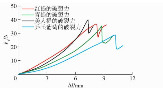
图 7 4 种单颗葡萄的力-变形曲线
