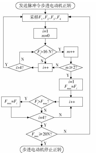
图 9 最大接触力控制流程图
