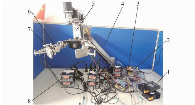
图 11 抓持-旋切式欠驱动双指手葡萄采摘装置样机
