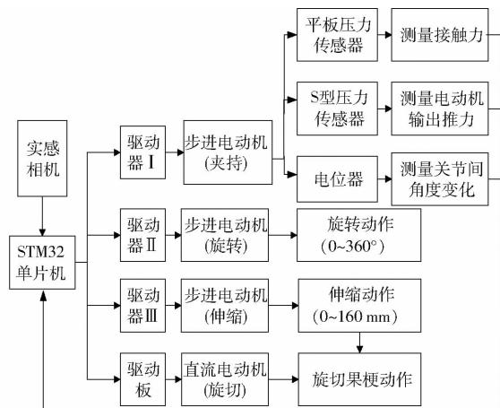
图 8 采摘装置控制系统硬件结构图
