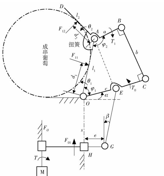
图3 欠驱动手指机构运动简图及受力分析
