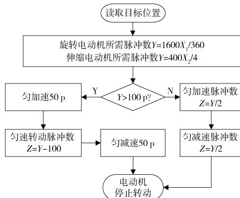
图 10 旋转电动机和伸缩电动机的运动控制流程图
