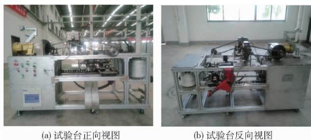
图10 打结器疲劳试验台
