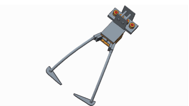
图 2 间苗锄刀结构图 Fig. 2 Structure diagram of thinning hoe
