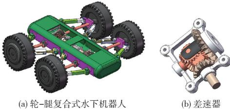
(a) 轮-腿复合式水下机器人 (b) 差速器
