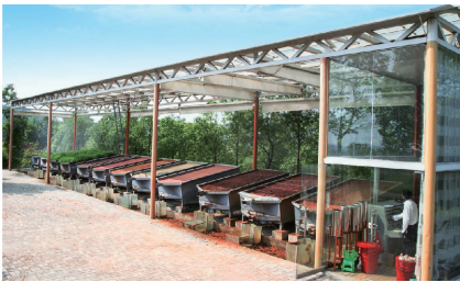
图 1 野外人工模拟降雨设备 Fig. 1 Field artificial rainfall simulator
