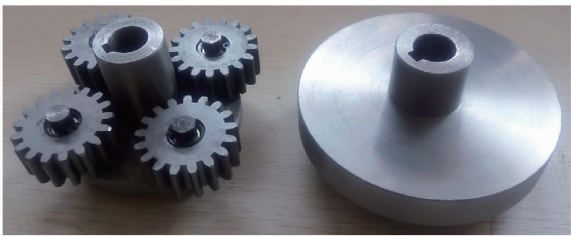
图 7 行星飞轮与单飞轮样机
