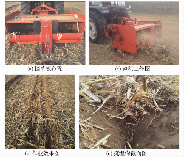
图 12 整机实物及作业效果图
