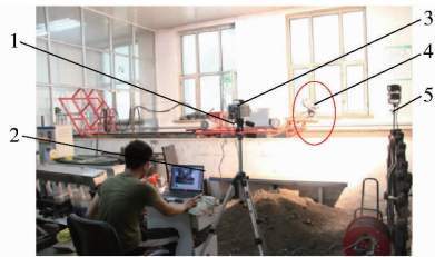
图7 斜置式非规则齿轮行星轮系扎穴机构高速摄像试验台
