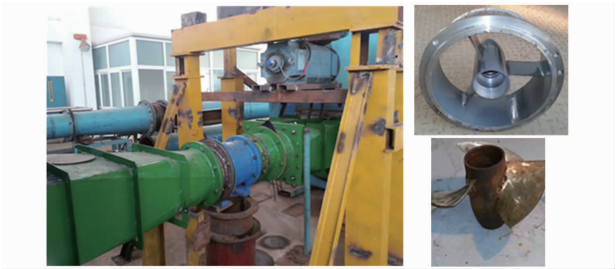
图 4 双向竖井贯流泵装置试验
