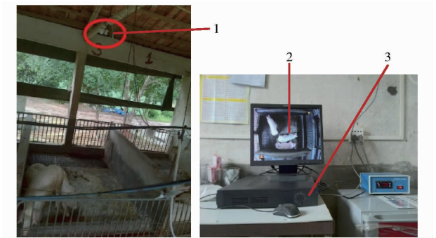
图 1 摄像机部署和 NVR 工作场景 Fig. 1 Arrangement of camera and NVR working 1. 摄像头 2. 监视器 3. NVR
