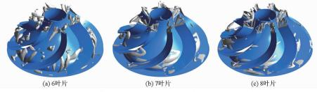
图 10 0.6 倍额定流量下空间导叶内部的涡核心区域图
