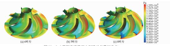
图 11 1.4 倍额定流量下空间导叶的静压分布
