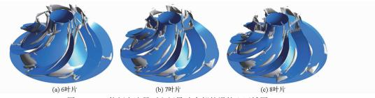
图 12 1.4 倍额定流量下空间导叶内部的涡核心区域图
