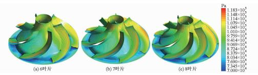
图 9 0.6 倍额定流量下空间导叶的静压分布
