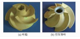
图 13 叶轮和导叶的 PPO 实体模型 Fig. 13 PPO solid model of impeller and diffuser
