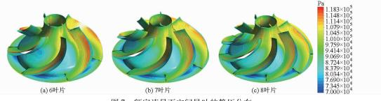
图 7 额定流量下空间导叶的静压分布
