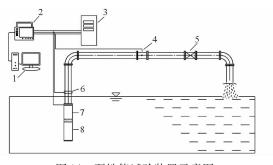
图 14 泵性能试验装置示意图
