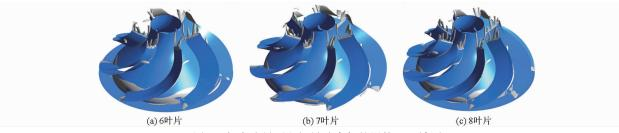
图 8 额定流量下空间导叶内部的涡核心区域图
