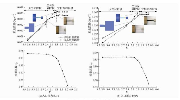
图 10 质量流量和流量系数随 K 变化曲线
