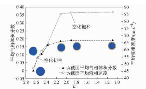
图 9 平均气相体积分数及平均液相速度随 K 变化曲线 Fig. 9 Average vapor volume fraction and average liquid flow rate changing with K
