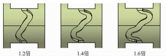
图19 不同惯性通道长度衬套 CAD 模型
