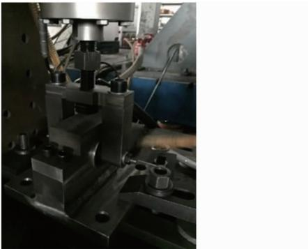
图5 整体试验台装夹图
