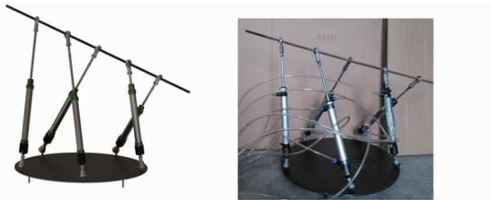
图 3 5-SPS 直线动平台并联机构实验样机
