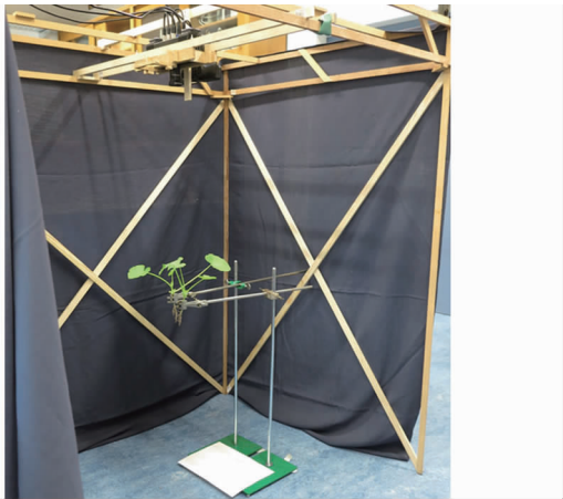
图 2 植物叶态 3D 图像采集装置
