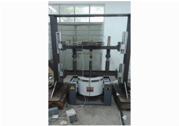
图 14 悬架试验系统 Fig. 14 Suspension test system
