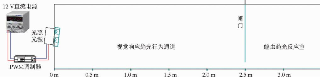
图2 LED波谱光照调控蝗虫视觉导向响应试验装置
