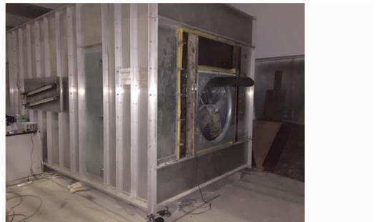
图 13 扰流风机性能测试实验装置
