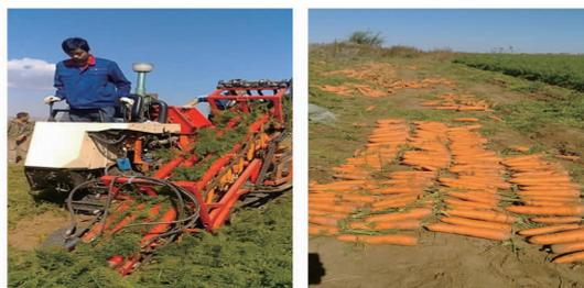
图 10 胡萝卜收获机田间试验
