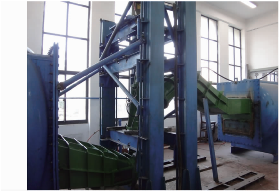
图 7 泵站立式轴流泵装置模型
