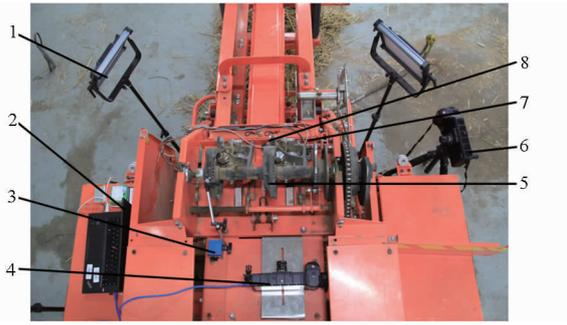
图4 同步获取系统布局图
