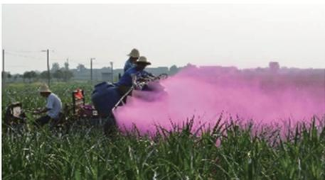
图3 三轮车载式喷杆喷雾机
