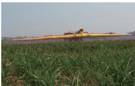
图2 3WQ-3000型牵引式风幕喷杆喷雾机
