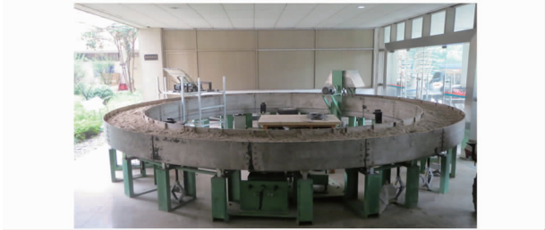
图 12 轮胎摩擦驱动的旋转式圆形土槽试验台
