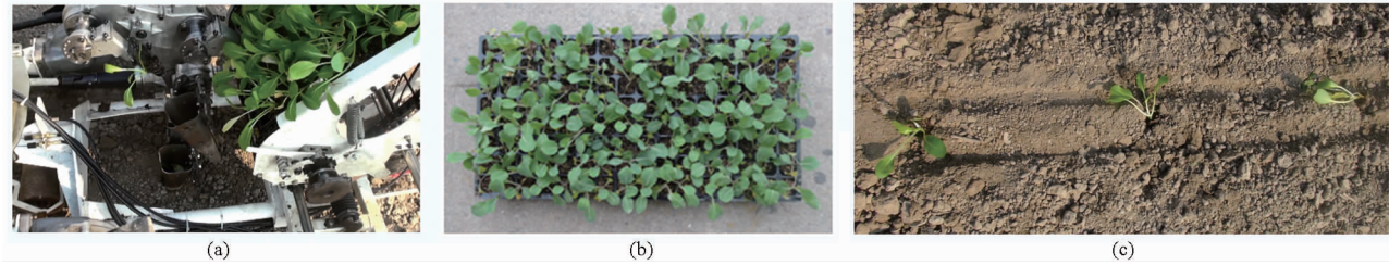
图 6 全自动移栽机田地栽植试验 Fig.6 Land test of automatic transplanting machine planting seedlings (a) 与取苗机构配合进行接苗栽植 (b) 钵苗盘 (c) 试验栽植的西兰花苗
