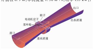
图 9 全贯流泵系统(电机泵)3D 剖面图 Fig. 9 3D profile of motor-pump system
