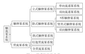
图 1 泵系统结构分类
