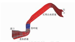
图 2 立式轴伸泵系统 3D 剖面图
