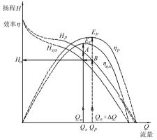
图 10 轴流泵选型新方法示意图
