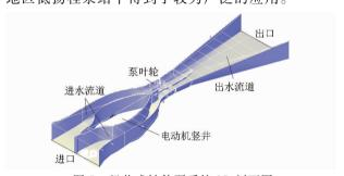
图 5 竖井式轴伸泵系统 3D 剖面图
