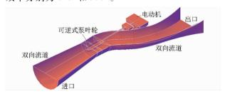
图 6 双向可逆轴伸泵系统 3D 剖面图
