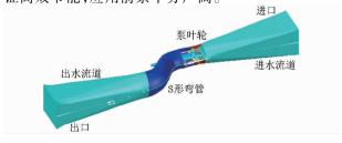
图 4 S 形轴伸泵系统 3D 剖面图
