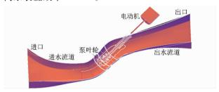
图 7 斜式轴伸泵系统 3D 剖面图
