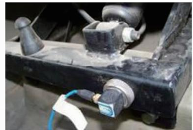
图9 座椅地板处加速度传感器安装位置图
