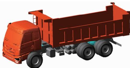
图 1 自卸车多体动力学模型
